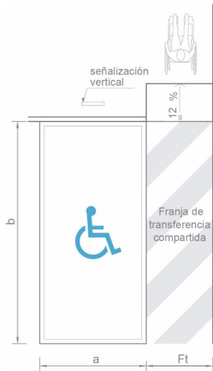
FIGURA 21. Señalización horizontal para plazas de estacionamiento para personas con discapacidad y movilidad reducida
